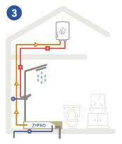
Das vorgewärmte Wasser wird nur zum Kessel geleitet.
