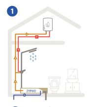
Das vorgewärmte Wasser wird in den Hahn und den Kessel geleitet. Die effizienteste Konfiguration.
